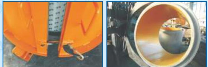
Um die erforderliche Maßhaltigkeit der Ringteile zu gewährleisten, wird empfohlen, die Herstellung im Gießverfahren mit Festentschalung zu bevorzugen oder bei Frischentschalung die Aushärtung der Schachtringe auf der Unter- und Obermuffe zu ermöglichen.
