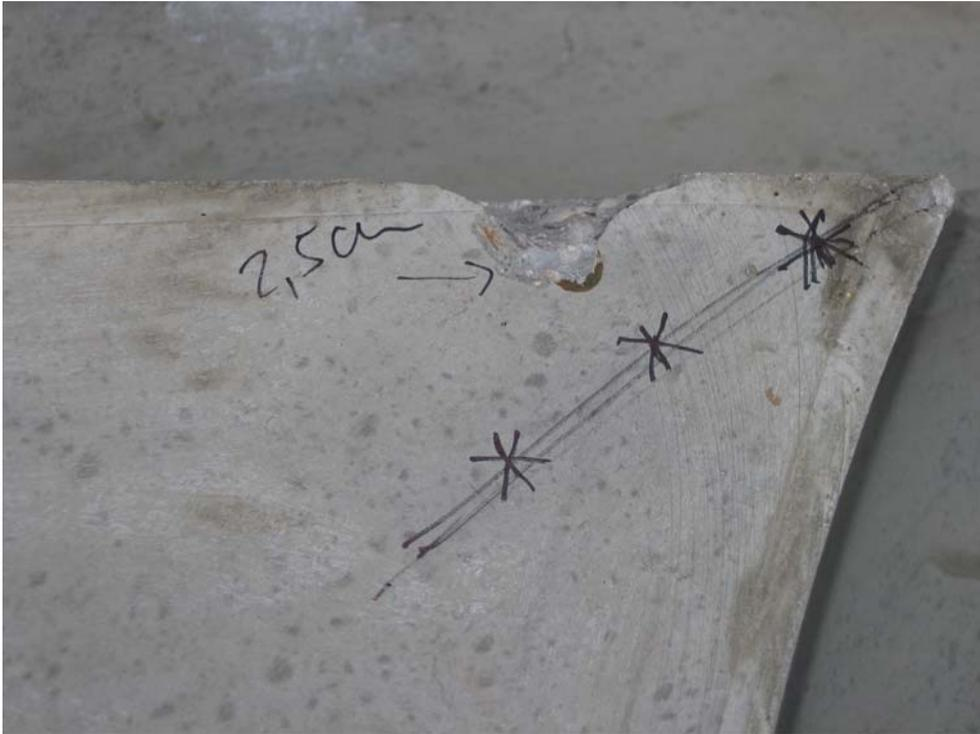
Abbildung 19: Betonschacht - 1,5 kg aus 3,0 m
