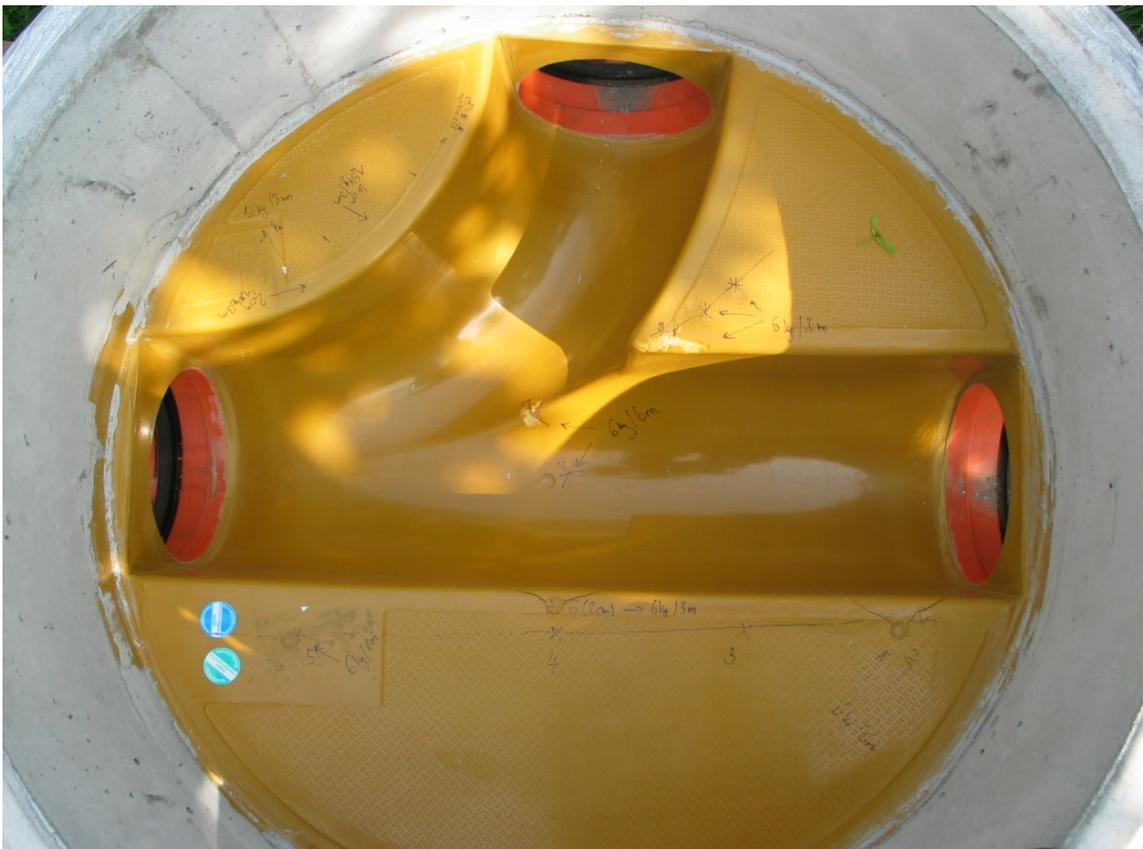
**Abbildung 7:** Prüfgut 7 / Fertigteilschacht mit Schachtauskleidung GFK
