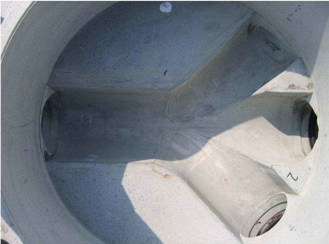
**Abbildung 2:** Prüfgut 2 / Fertigteilschacht aus Beton
