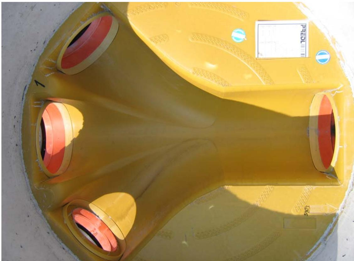
**Abbildung 1:** Prüfgut 1 / Fertigteilschacht mit tiefgezogener Schachtauskleidung in PP
